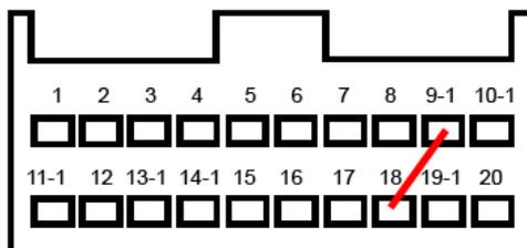
Рис. 3. Установка перемычки на колодку иммобилизатора.
